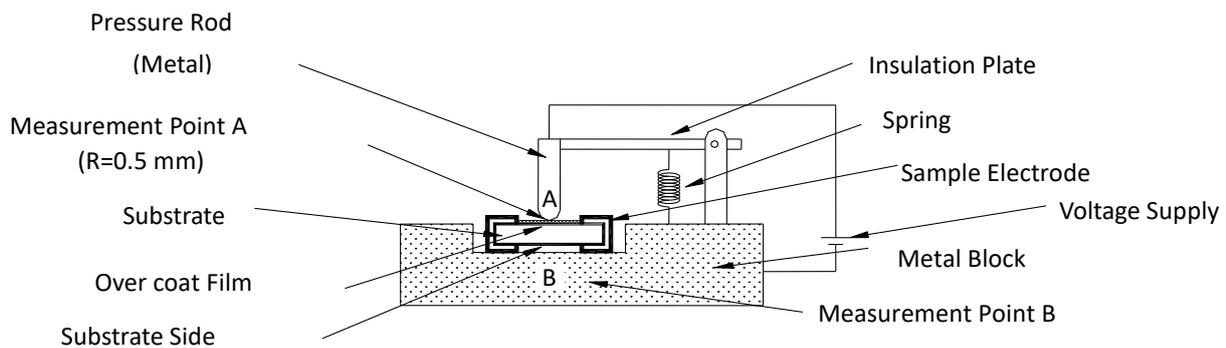
Figure 1 : Measurement Setup
